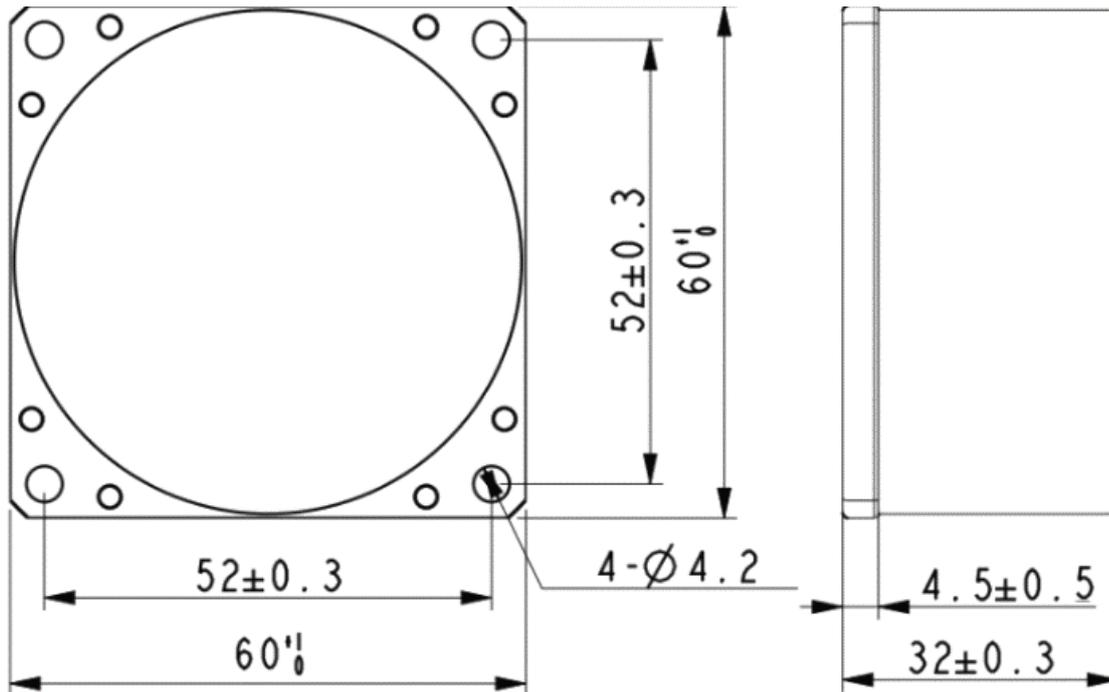
图 1 AgileLight-600 系列光纤陀螺外形尺寸
